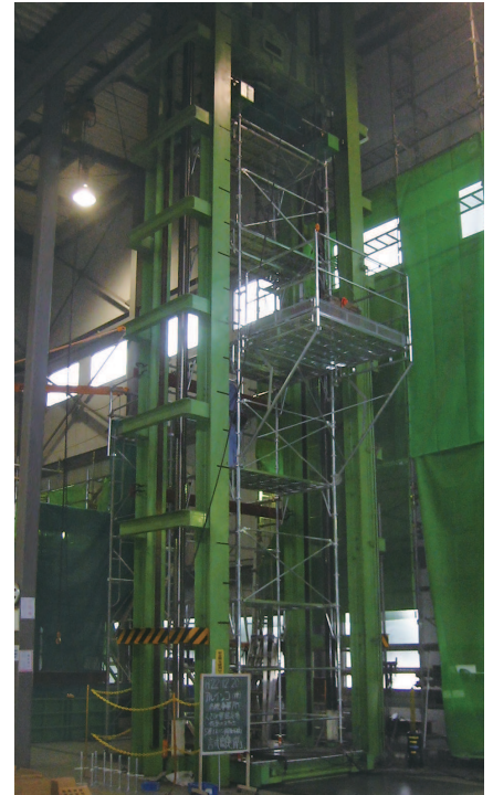
偏芯荷重に鉛直荷重を加えた過酷な実大実験 仮設工業会東京試験所
